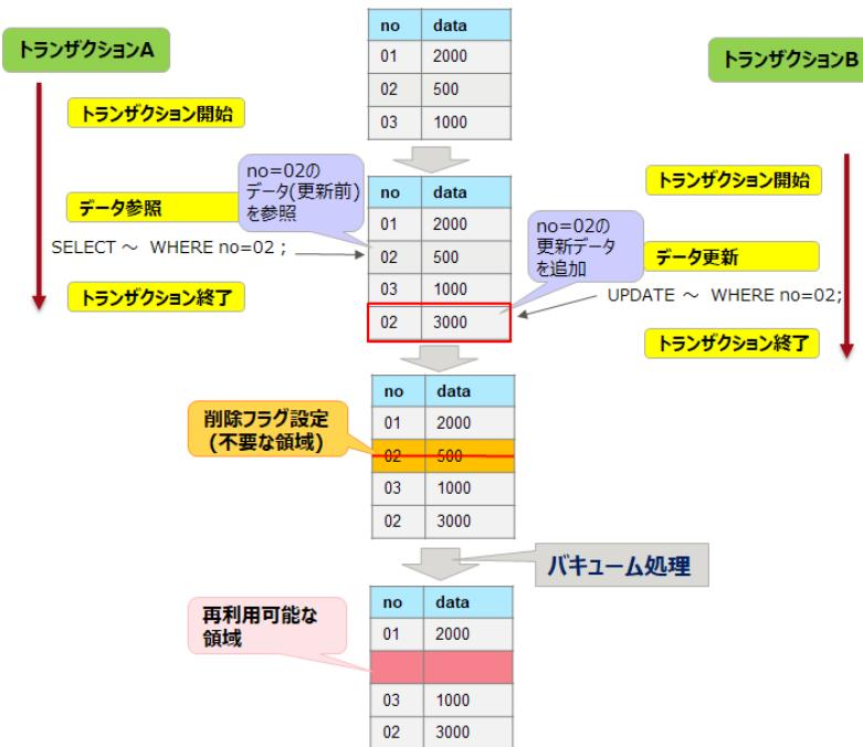
バキューム処理は、通常、自動バキューム機能により自動的に行われますが (postgresql.conf の autovacuum パラメーターのデフォルト値が有効)、より効果的に行われるよう、自動バキュームに関するパラメーターを調整します。
