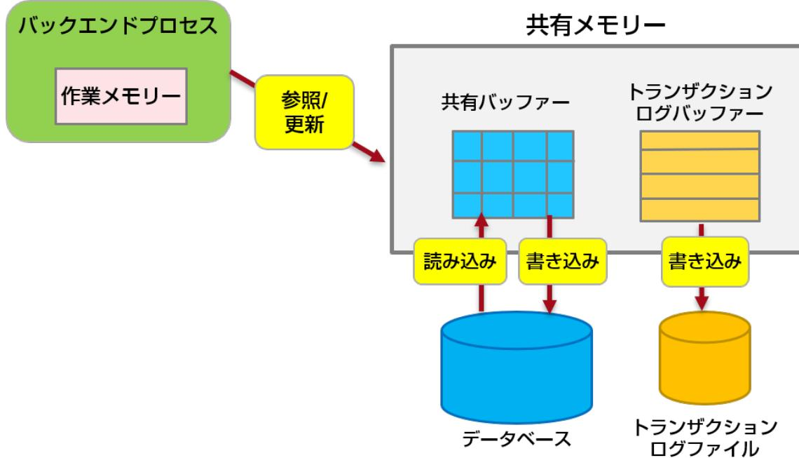
データベースチューニングでは、これらの仕組みをもとにメモリーを適切に割り当てて、ディスク I/O を減らすことで、データベースの処理性能を高めていきます。
